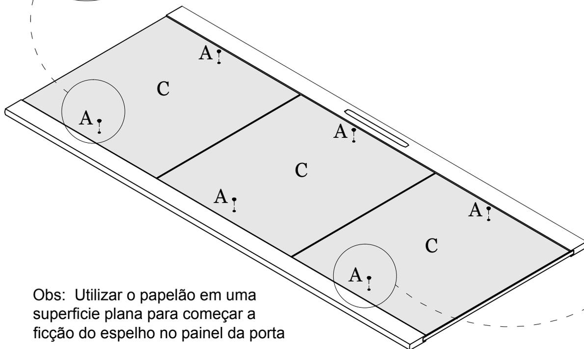
Obs: Utilizar o papelão em uma superfície plana para começar a fixação do espelho no painel da porta
